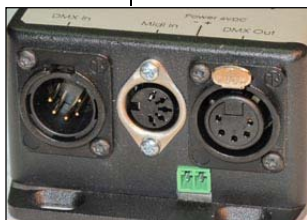
Connecteurs à contacts dorés XLR 5 p ôles DMX IN & OUT.
