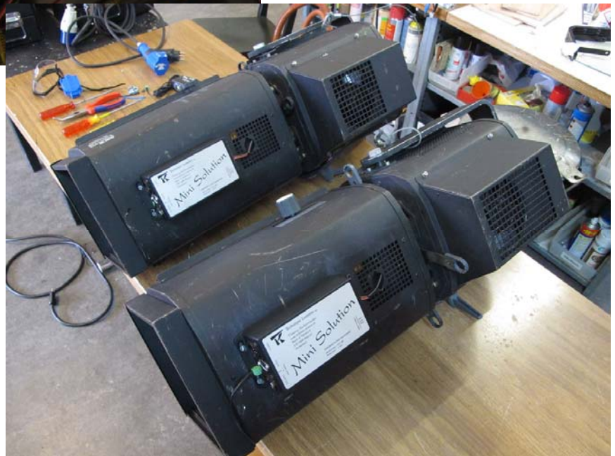
Re-motorisation d'iris de découpe HMI.
